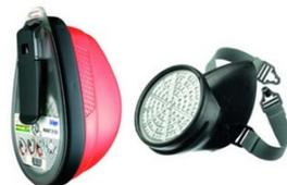
Equipé d'un filtre multi-gaz ABEK-15. Rangé dans son boîtier robuste et ergonomique, il est compact et facile à transporter. Homologué selon la seule norme reconnue relative aux dispositifs d'évacuation industriels filtrants (DIN 58647-7), il laisse à son porteur un temps d'évacuation d'au moins 15 minutes
