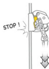
En cas de mouvement brusque (chute, glissade, descente non contrôlée...), l'antichute se bloque sur la corde et immobilise l'utilisateur
