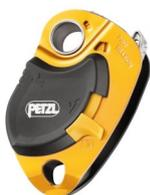
**Poulie-bloqueur** PRO TRAXION est conçue pour pouvoir installer la corde lorsque la poulie est fixée à l'ancrage. Avec son réa de gros diamètre et son rendement très important, elle est particulièrement adaptée au hissage de charges lourdes. Le flasque verrouillé sous charge empêche l'ouverture de la poulie en cours d'utilisation. Le point de connexion inférieur permet de réaliser différents types de mouflages.
