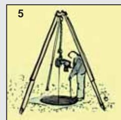
Levage de charge au-dessus d'un puits
